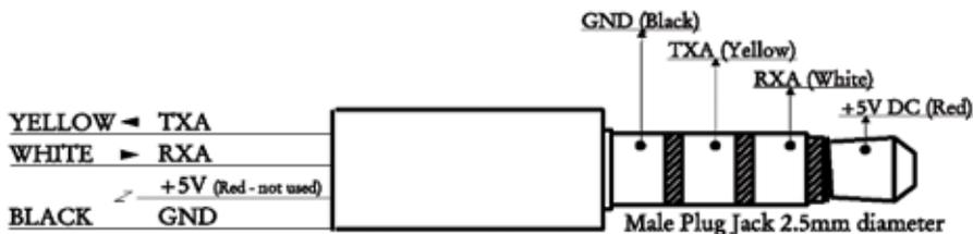
Fig. 15 - Connettore seriale
