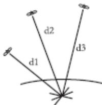
Fig. 7.2a - Rilevamento della posizione con il GPS
